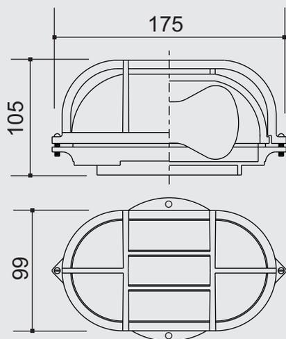
**Especificação:** Arandela em alumínio injetado pintado por processo eletrostático. Vidro prismático transparente e grade de proteção. Borracha de vedação e parafusos em aço inox.
