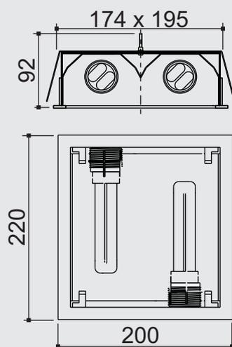
**Especificação:** Embutido retangular em alumínio pintado por processo eletrostático. Refletor em alumínio anodizado de alto brilho e vidro fosco. Fixação ao forro por meio de suporte metálico.
