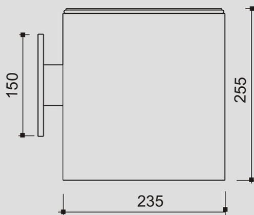
Especificação: Arandela cilíndrica em alumínio tratado e pintado por processo eletrostático. Refletor interno em alumínio. Alojamento interno para equipamento.
