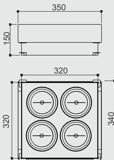
**Especificação:** Embutido retangular com difusor em policarbonato recuado sem moldura fabricado em alumínio pintado por processo eletrostático. Com sistema de orientação do foco da lâmpada e fixação ao forro através de suporte metálico
