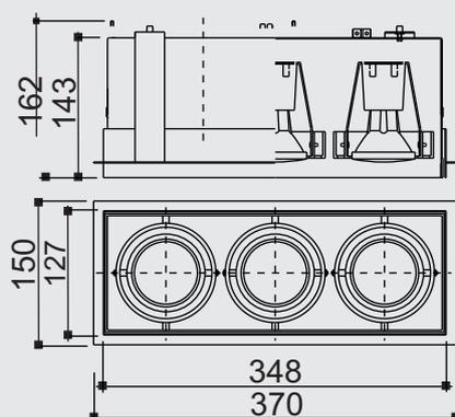
**Especificação:** Caixa mix embutida retangular no frame fabricado em alumínio pintado por processo eletrostático. Sistema de orientação do foco da lâmpada. Fixação chumbada ao forro.
