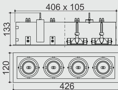
**Especificação:** Caixa mix embutida retangular em aço tratado por fosfatização e alumínio pintado por processo eletrostático. Sistema de orientação dos focos das lâmpadas. Fixação ao forro por meio de suporte metálico.
