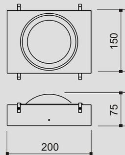
Módulo em perfil de alumínio tratado e pintado por processo eletrostático com sistema de orientação da lâmpada.
