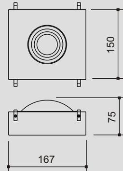
Módulo em perfil de alumínio tratado e pintado por processo eletrostático com sistema de orientação da lâmpada.
