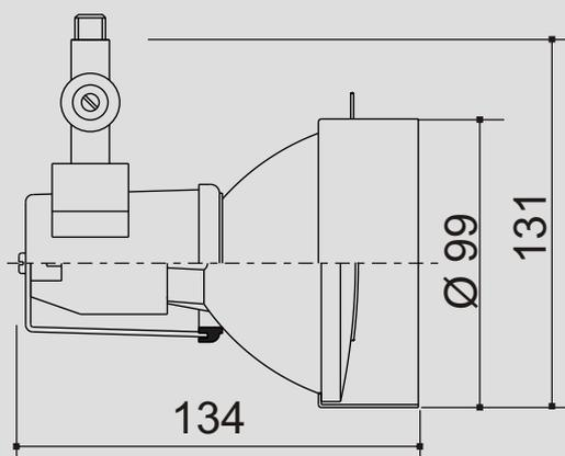
Especificação: Spot com anel anti-ofuscamento em alumínio pintado por processo eletrostático. Fixação através de canopla com Ø130mm.
